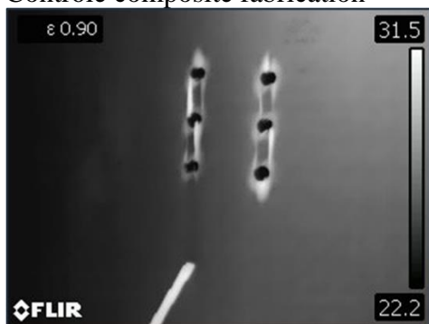
Délamination après perçage
