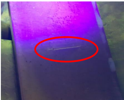
Défaut de soudure
